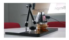
Der Messtisch ermöglicht dem Bediener freihändig zu arbeiten. Das Prüfgerät kann frei in jede Position zur Messprobe gebracht werden. Ideal für unförmige Messstücke, besonders im DPM-Bereich.
